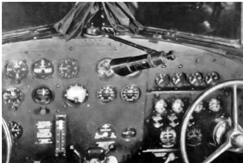
Приборная панель «Ауста». Посередине — регулируемая лампа, которой можно подсветить приборы как удобно
