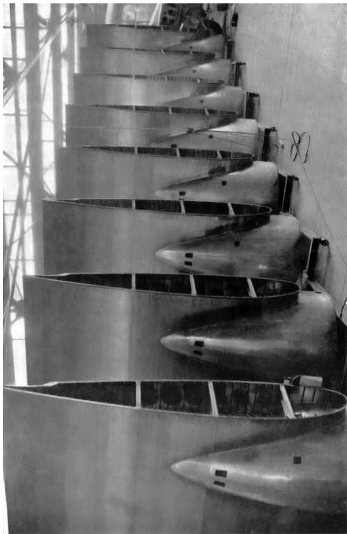
НА ЗАВОДЕ ДУГЛАСА Центральные секции крыльев с мотогондолами ждут своей очереди на установку под фюзеляжи
