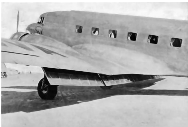
На этом снимке хорошо видно выпущенные закрылки
